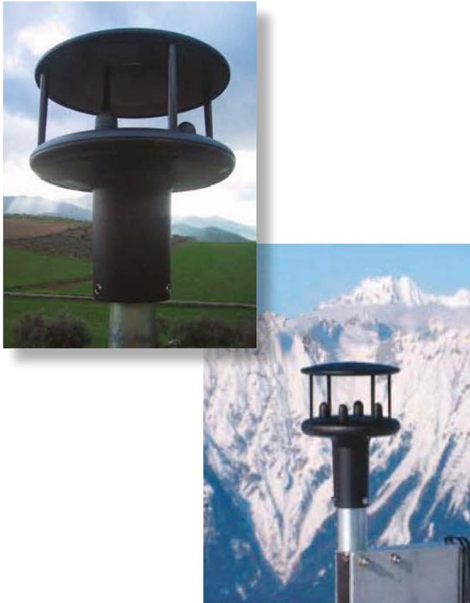
**GEO-WS** es un sensor de viento ultrasónico robusto y de bajo coste, por tanto sin partes móviles. Este sensor de viento ultrasónico biaxial ofrece una medida de la velocidad y dirección del viento sin necesidad de mantenimiento, una vez instalado.
